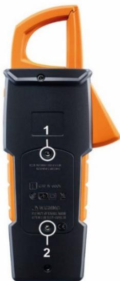
2. Desserrer les deux vis métalliques (1, 2) du compartiment à piles au moyen d'un tournevis jusqu'à ce que le couvercle du compartiment à piles puisse être retiré. Ne pas dévisser totalement les vis.
