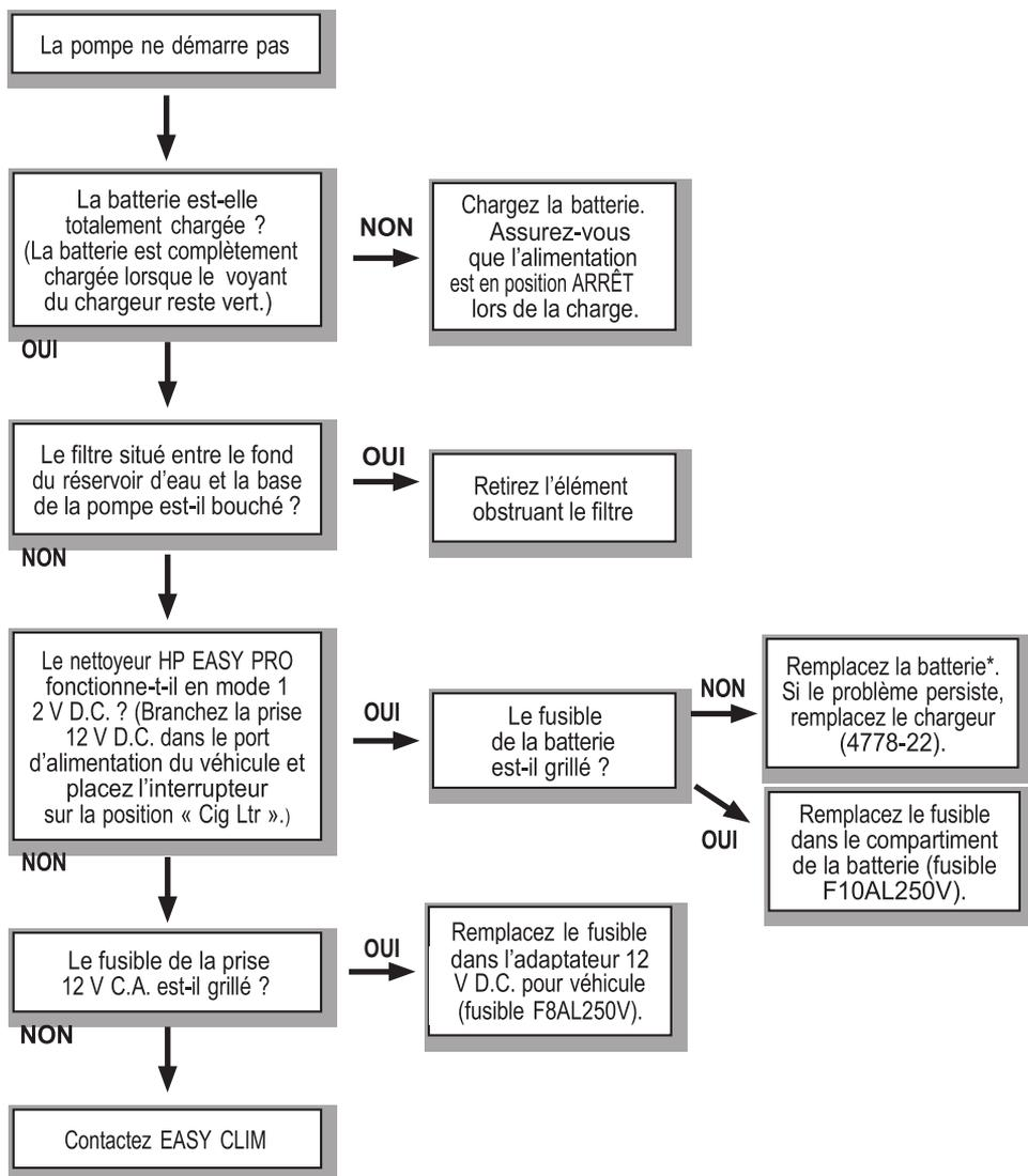
\* Remplacez par une batterie rechargeable au plomb Expert Power (EXP 1245)
