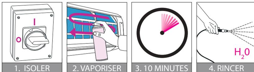
Isoler les circuits électriques. Pulvériser le produit en commençant par le haut, puis en allant de droite à gauche et progressivement vers le bas. Bien imbiber le serpentin. Laisser détrempé pendant 10 minutes. S'assurer qu'EasyCare® a bien pénétré à l'intérieur du serpentin. Rincer abondamment à l'eau claire.
